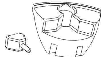
La surface de contact entre la bague de rayon et les têtes de rayon est un cône à 5° (voir DT5). Le serrage des 3 vis de maintien provoque l'avance de la bague étoile qui vient presser les têtes de rayon sur les flancs du flasque. Le jeu résiduel étant faible, cela nécessite une bonne précision des pièces assemblées.
