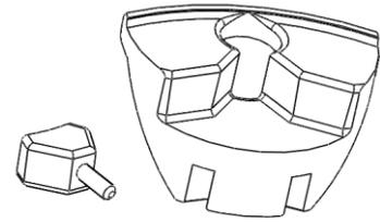
Pour faciliter l'usinage, l'équipe de fabrication envisage une modification de la forme du flasque. Cela provoque une réduction de surfaces d'appui des têtes de rayon et donc une augmentation de la pression de contact. Avant de proposer la modification de forme au bureau d'étude, l'absence de matage doit être vérifiée.
