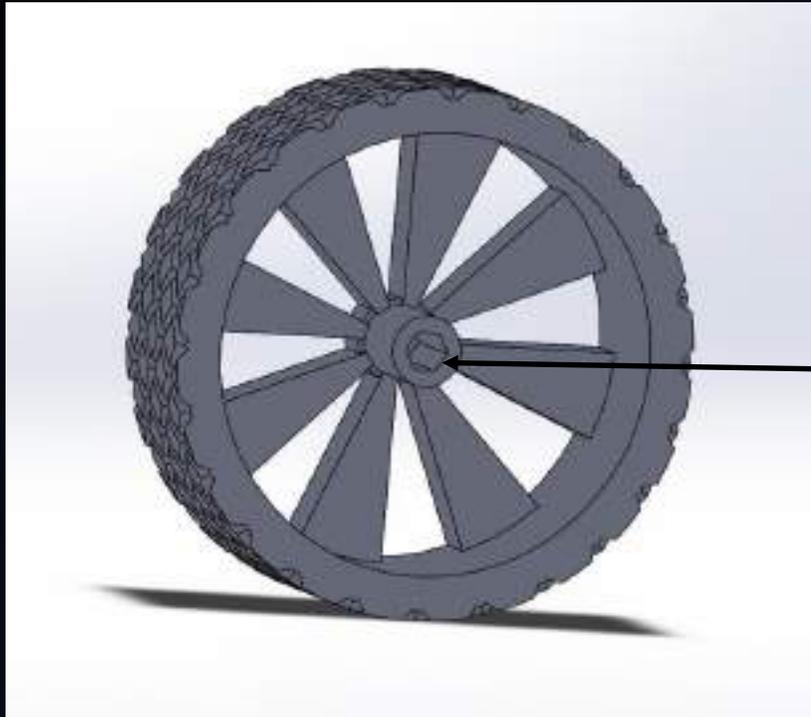
La taille de l'axe était trop petite, on l'a donc redimensionné sur solidworks avec des bagues d'axes de taille différentes.
